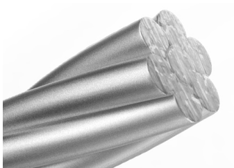
CABLE DESNUDO ALUMINIO 50 MM 2 (7 HILOS Ø 3,02 MM)
