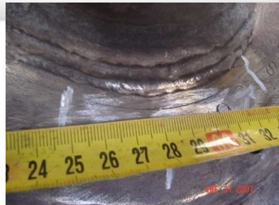
FISURAS DETECTADAS CON PARTICULAS MAGNETIZABLES
