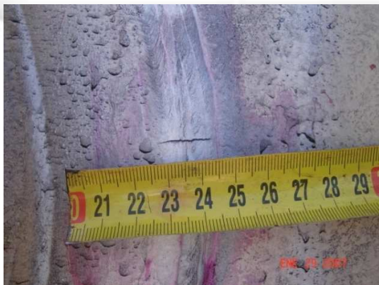
FISURAS DETECTADAS CON PARTICULAS MAGNETIZABLES
