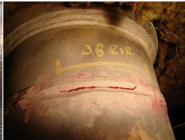
FISURAS DETECTADAS CON LIQUIDOS PENETRANTES
