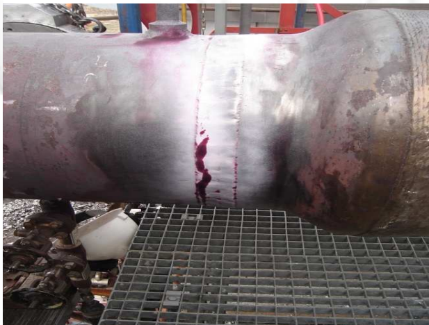
FISURAS DETECTADAS CON LIQUIDOS PENETRANTES
