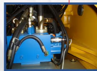
c) Sensor de carga para controlar la presión de elevación
