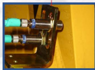
b) Sensor de proximidad para medir la velocidad de elevación
