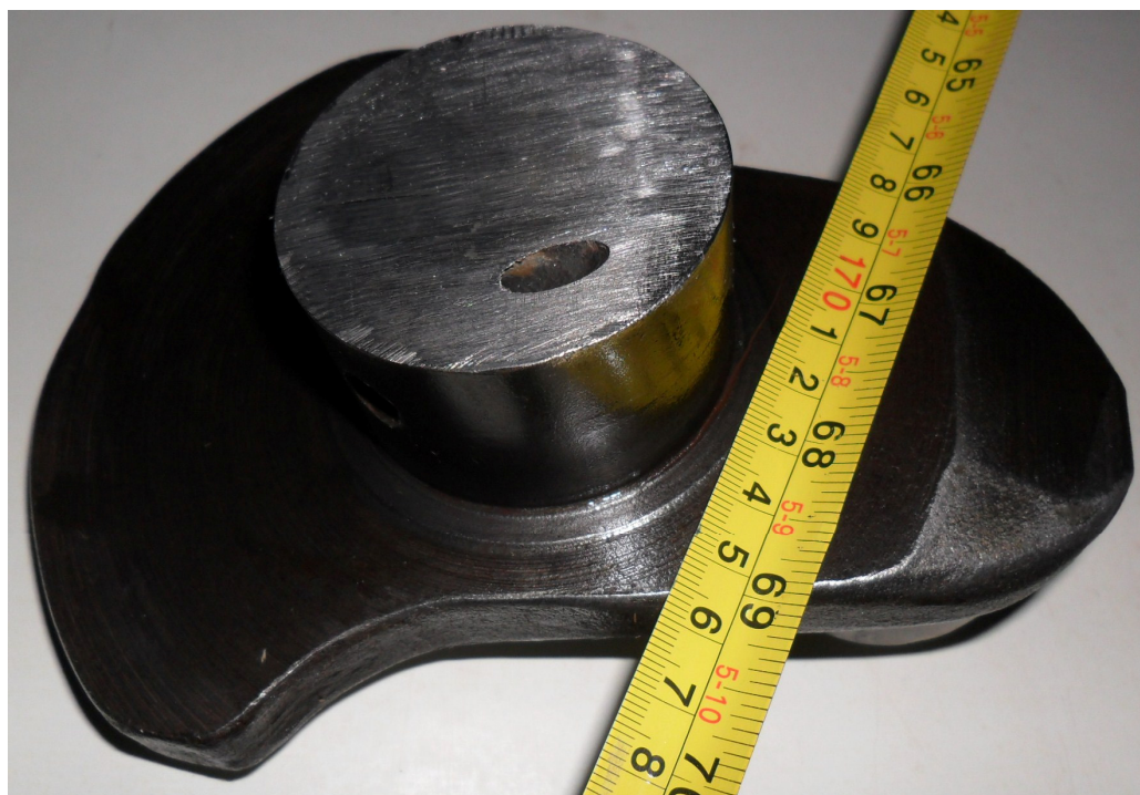
VISTA LATERAL SUPERIOR DE LA MUESTRA, CON LA REGLA UBICADA PRÓXIMA A LA DISCONTINUIDAD ENTRE MUÑOÓN Y CONTRAPESO.
