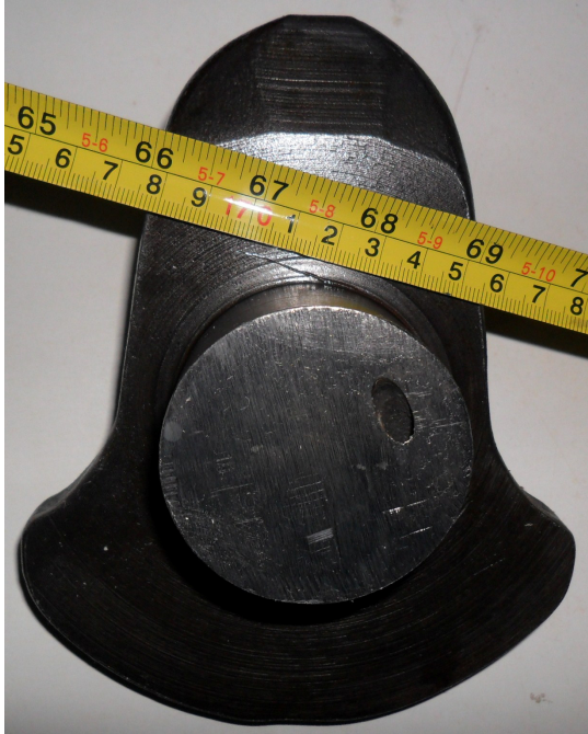
PRUEBA 1): ENSAYO CON PARTÍCULAS ROJAS VÍA HÚMEDA SIN FONDO AUXILIAR DE CONTRASTE. LA DETECTABILIDAD ES DEPENDIENTE DEL GRADO DE CONTRASTE ENTRE OTROS FACTORES.
