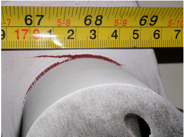
PRUEBA 2): ENSAYO CON PARTÍCULAS ROJAS VÍA SECA CON FONDO BLANCO AUXILIAR DE CONTRASTE. OBSÉRVESE QUE ADEMÁS DE LA DISCONTINUIDAD LINEAL, SE VE OTRA DISCONTINUIDAD PERIMETRAL AL MUÑÓN. AMBAS DISCONTINUIDADES APARECEN CON DEFINICIÓN MEDIA.
