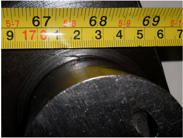
PRUEBA 1): ENSAYO CON PARTÍCULAS ROJAS VÍA HÚMEDA SIN FONDO AUXILIAR DE CONTRASTE. LA DETECTABILIDAD ES DEPENDIENTE DEL GRADO DE CONTRASTE ENTRE OTROS FACTORES.
