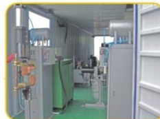
■ 前视图：上托氏管一体焊机，下托焊机 Front view: top cap and venturi welder, bottom cap welder
